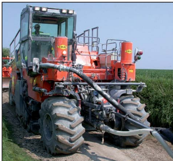
Eco-recycleur, décohesionneur et mélangeur
